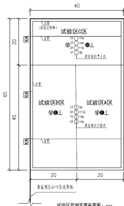
试验区监测平面布置图 1:250
